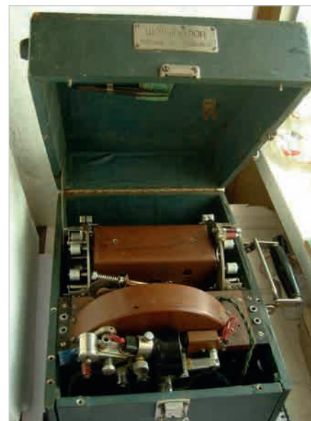
Рис. 4. Шоринофон с возможностью записи звука на целлулоидные диски
