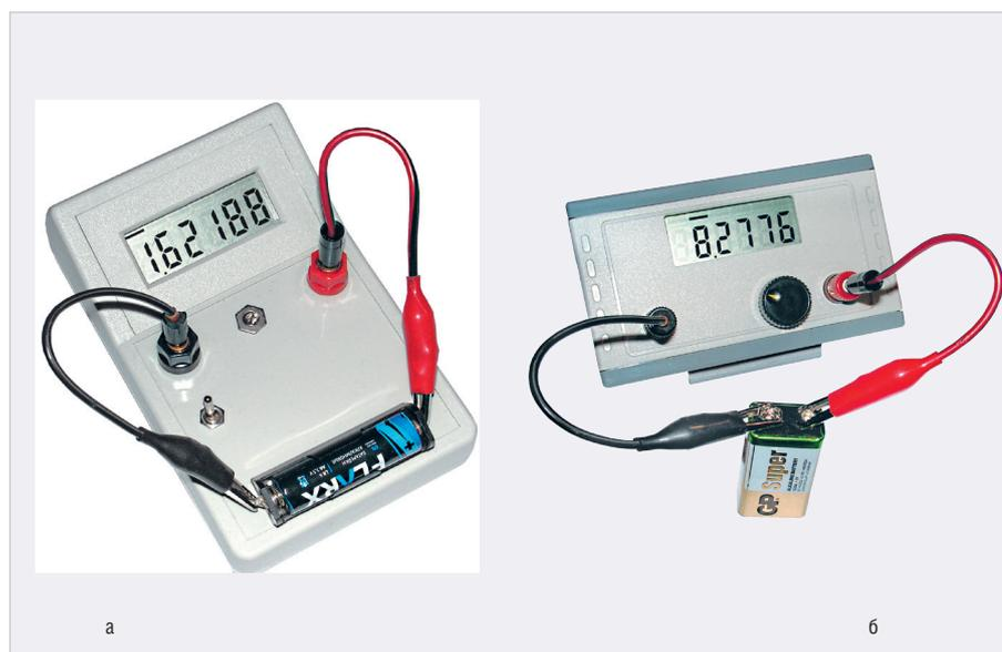
Рис. 27. Измерение напряжения: а) щелочной батарейки AA; б) батареи «Крона»
