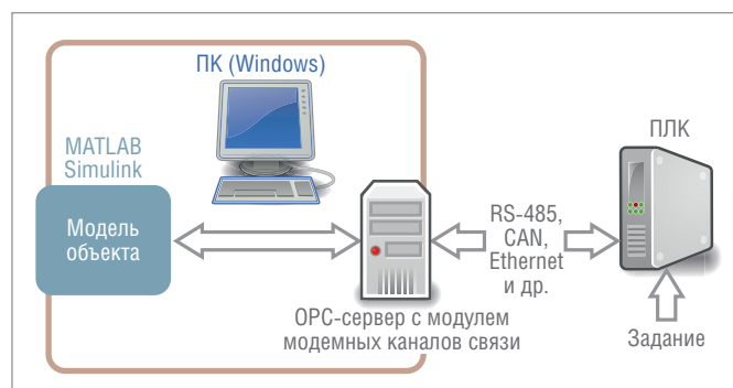
Рис. 3. Функциональная схема аппаратно-программного комплекса
