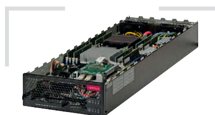
Рис. 5. Компоновка и охлаждение вычислительного модуля ОСР
