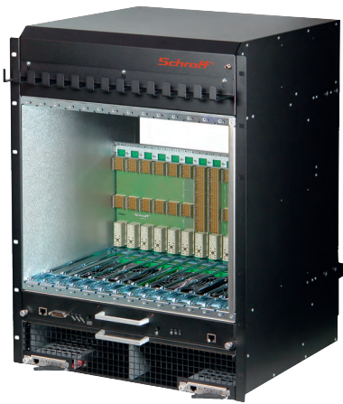
Рис. 2. Внешний вид шасси AdvancedTCA
