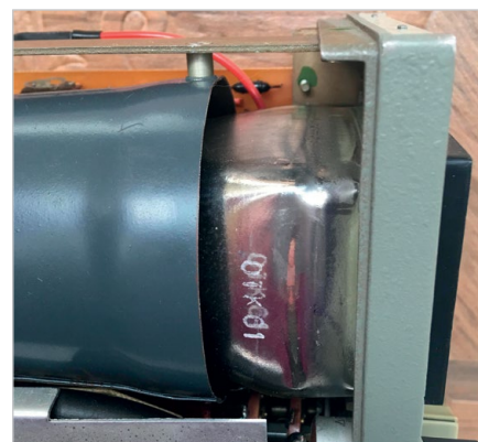
Рис. 6. Крепление раструба пермаллового экрана
