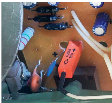
Рис. 2. Монтаж элементов D5, C7, R8
