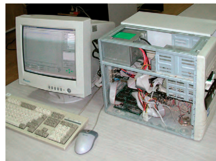
Рис. 4. Рабочее место оператора и устройство числового программного управления, выполненное на базе персонального компьютера с модулями ввода-вывода формата MicroPC
