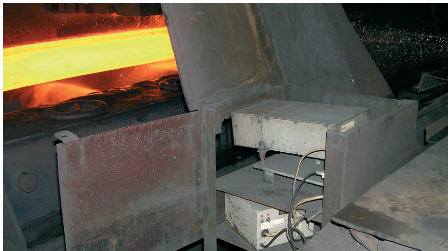
Рис. 5. Расположение оптического измерителя относительно подающего рольганга
