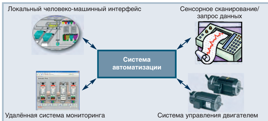
Рис. 2. Пример упрощённой системы автоматизации
