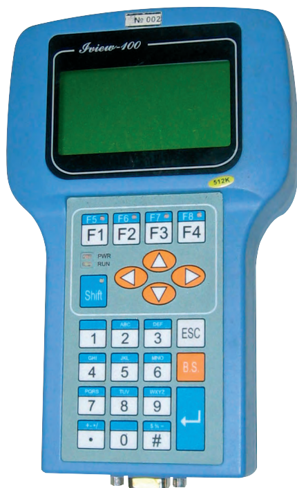
Рис. 4. Портативный контроллер, используемый в качестве программатора
