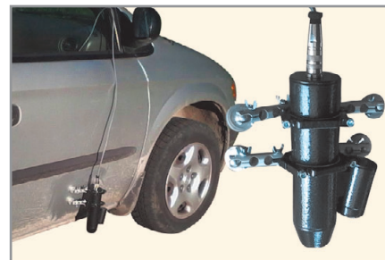
Рис. 2. Применение бесконтактного оптического датчика скорости
