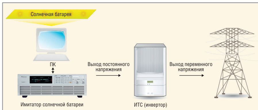
Рис. 4. Интерфейс для оценки параметров инверторов солнечных батарей
