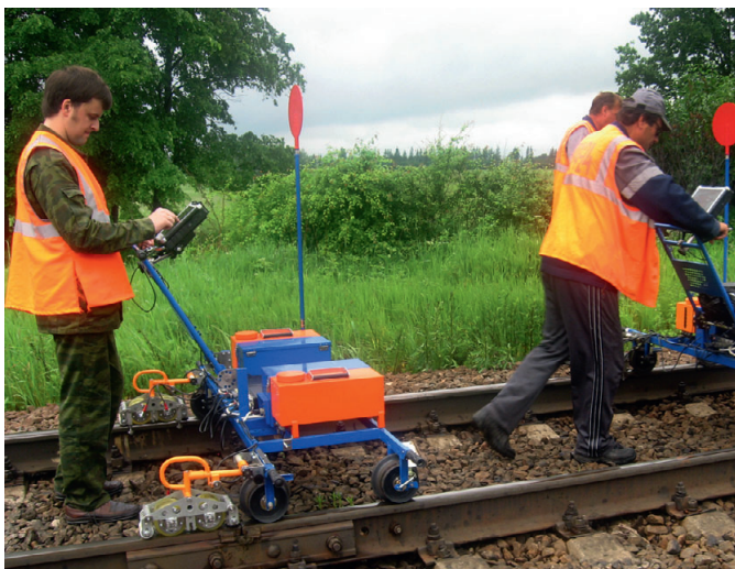
Рис. 7. АВИКОН-14 – первый в России дефектоскоп на базе колёсных ультразвуковых преобразователей
