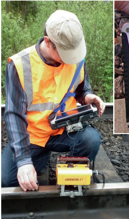
Рис. 9. Специализированный дефектоскоп АВИКОН-17 для обнаружения опасных трещин в головке рельсов под поверхностными повреждениями и для ручного контроля рельсов
