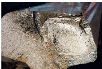
Рис. 4. Развитие поперечной трещины от повреждений на рабочей выкружке головки рельса
