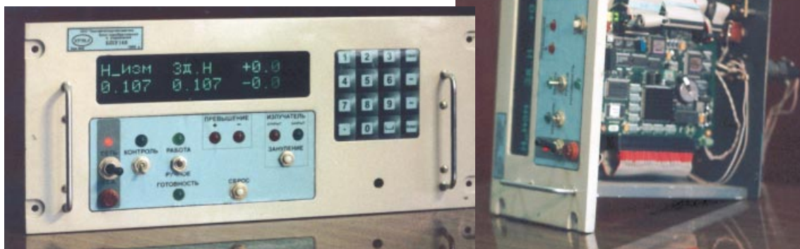
Рис. 3. Лицевая панель и внутренняя конструкция БПУ
