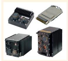
Модуль C535 фирмы Aitech (Израиль) выполнен в формате VPX 3U и имеет производительность более одного терафлопс при потребляемой мощности максимум 17 Вт (60 гигафлопс на 1 Вт).
