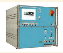
Многофункциональное устройство связи/ развязки (CDN) обеспечивает подачу помех в линии электропитания испытуемых технических средств, что исключает потери времени на переключения и затраты на дополнительные внешние CDN.
