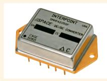
Серия SMHF42 включает 15-Вт одно- и двухканальные модули с гальванической развязкой для работы в диапазоне входного напряжения от 35 до 55 В, способные выдерживать импульсные напряжения 80 В длительностью 50 мс.
