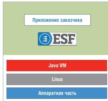
Рис. 2. Структура шлюза IoT
