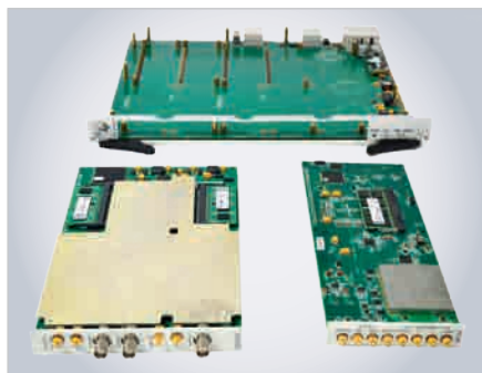
Рис. 7. Носитель стандарта AXIe и измерительные мезонины
