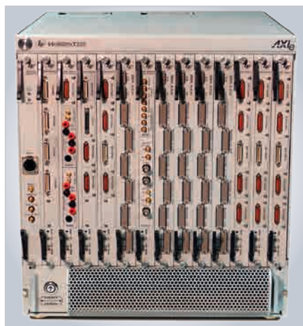
Рис. 6. Крейт стандарта AXIe на 14 слотов
