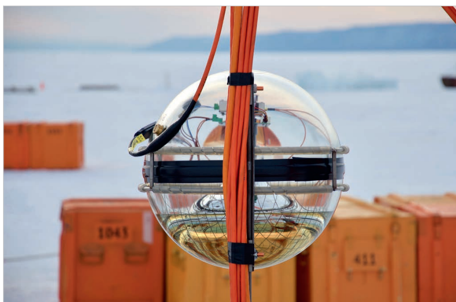
Рис. 11. Оптический модуль нейтринного телескопа Baikal-GVD
