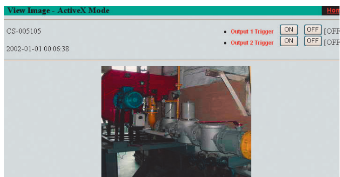
Рис. 5. Встроенный Web-интерфейс IP-видеокамеры
