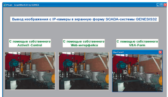
Рис. 3. Результат вывода изображения с IP-видеокamеры в экранную форму GraphWorX
