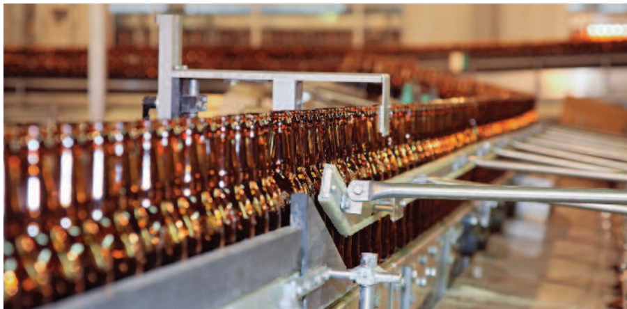
Рис. 2. Отбраковка и подсчёт бутылок на конвейере
