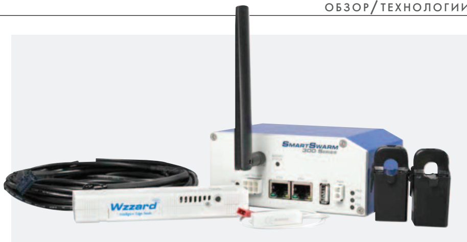
Рис. 9. Стартовый набор BB-WSK-REF-2 для мониторинга холодильных систем
