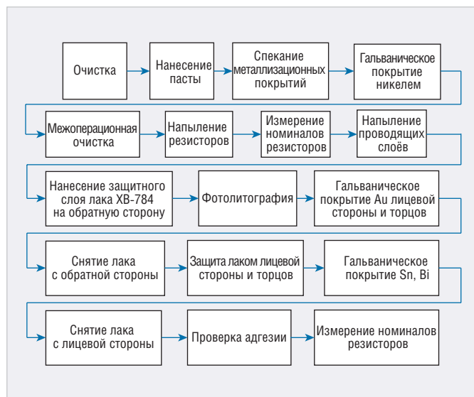
Рис. 2. Технологическая схема комбинированного метода изготовления плат
