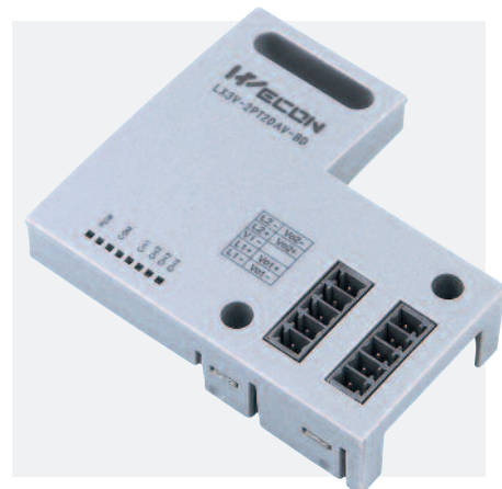
Рис. 4. 4-канальная плата расширения LX3V-2PT2DAV
