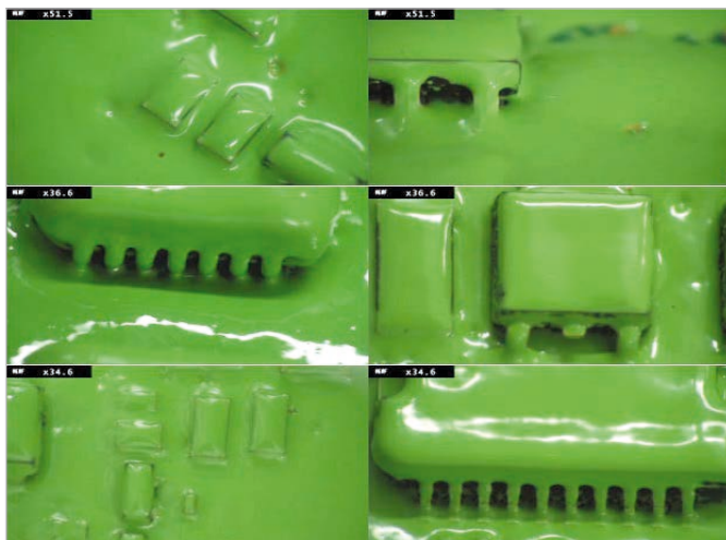
Рис. 7. УФ/химически отверждаемое покрытие после 1000 циклов теплового удара (от -40 до +130°C)
