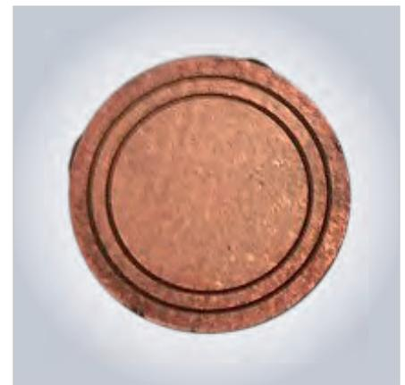
Рис. 7. RFID-метка IDN – 0101 на кольцевых щелевых резонаторах с двумя резонансными состояниями
