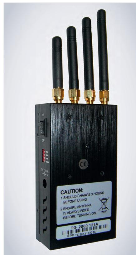
Рис. 2. Вид электронного «глушителя», делающего большинство популярных меток в системе RFID бесполезными
