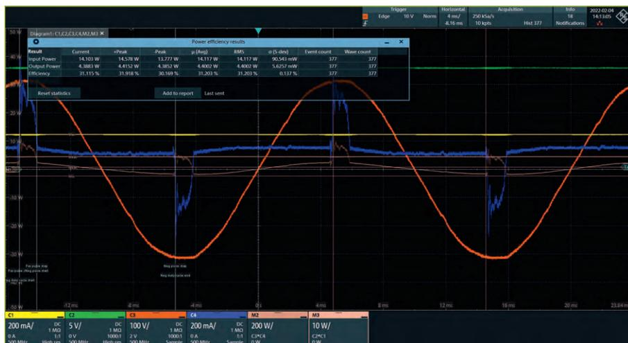
Рис. 15. Результаты измерений коэффициента полезного действия для импульсного ИВЭП
