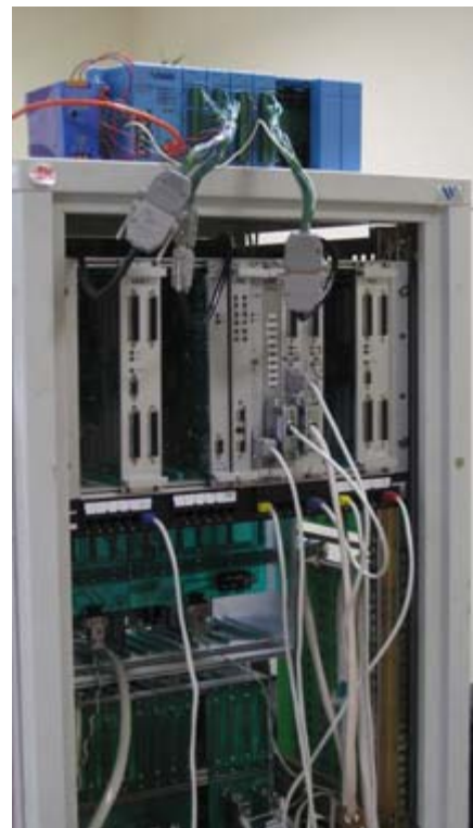
Рис. 2. Подключение микроконтроллера АДК к проверяемому оборудованию КП
