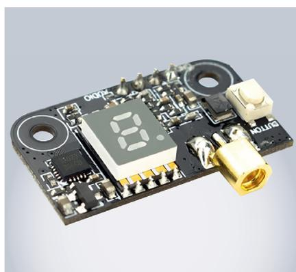
Рис. 4. IPX-разъём для антенны
