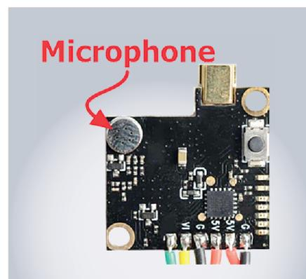
Рис. 5. Вид микрофона на видеопередатчике
