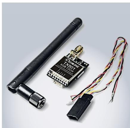
Рис. 1. Видеопередатчик
