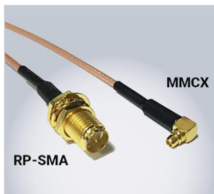
Рис. 3. Варианты разъёмов антенн
