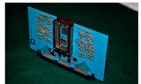
Рис. 26. Фотография 3D ФЭ МПМ с 3D ФЭ матрицами функциональных СБИС с оптическими и электрическими связями
