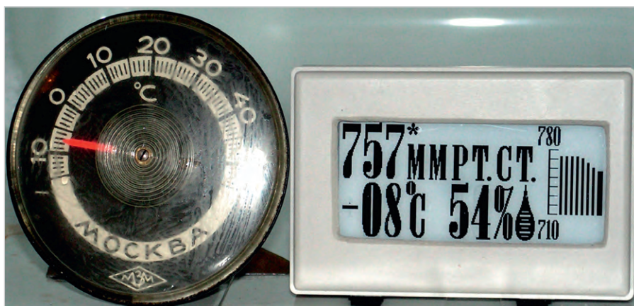
Рис. 9. Показания прибора и уличного термометра, помещённых в морозилку холодильника на час
