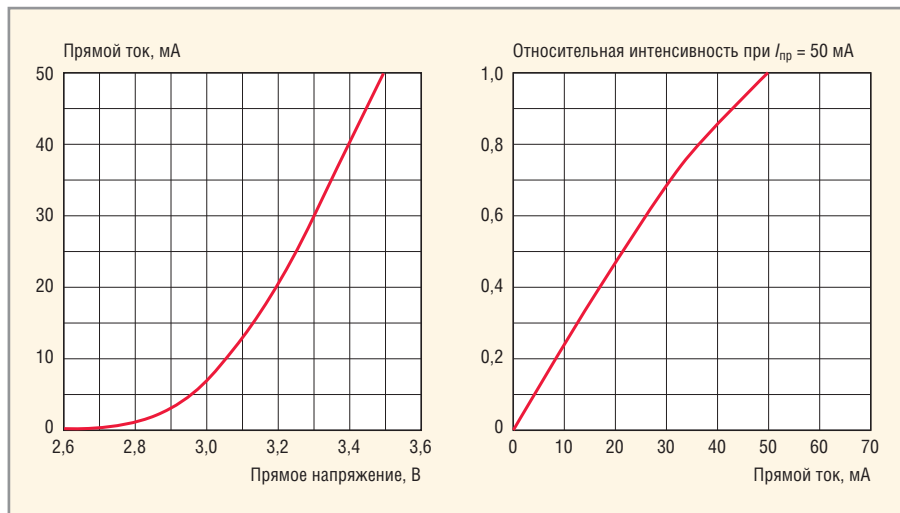
Рис. 13. Зависимости прямого тока от прямого напряжения и интенсивности излучения от прямого тока светодиода L-7700C4VGC-Z
