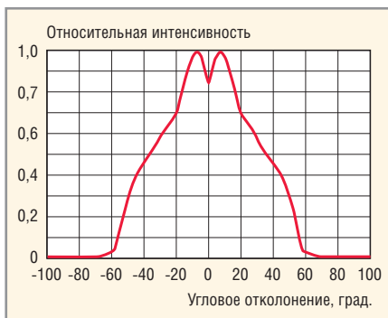
Рис. 15. Диаграмма распределения силы света светодиодов серии L7679
