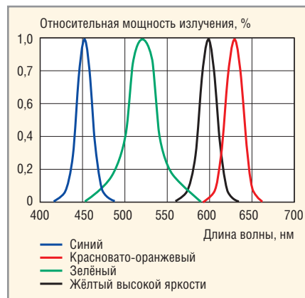
Рис. 7. Спектральные характеристики светодиодов серии KTDG-8080
