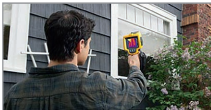
Рис. 16. Обследование дома для выявления мест потери тепла
