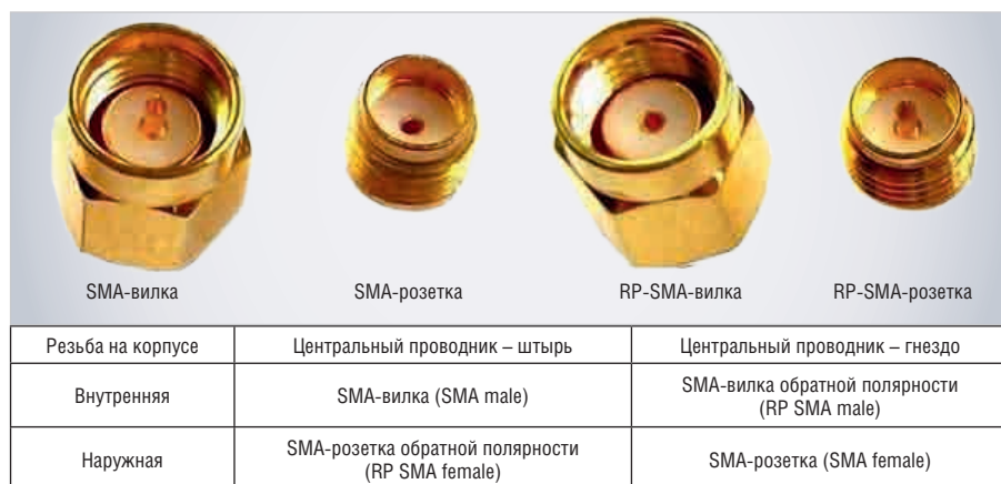
Рис. 1. Соединители SMA прямой и обратной полярности
