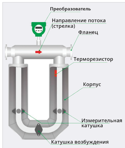
Рис. 11. Принцип работы кориолисового расходомера
