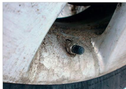
Рис. 3. Смонтированный на диске колеса электронный датчик с модулем беспроводной связи и «безбатарейным» источником питания
