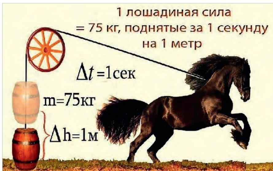
Рис. 5. Иллюстрация определения «лошадиной силы»
