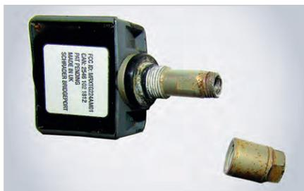
Рис. 1. Датчик уровня давления воздуха в колесе бескамерного исполнения автомобиля Субару
