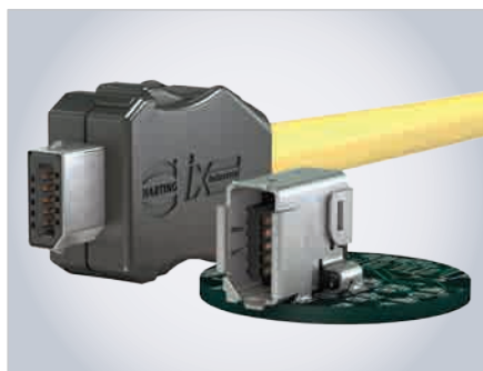
Рис. 2. Фиксация ответных частей ix Industrial (слева) и розетка ix Industrial, смонтированная на печатной плате (справа)
