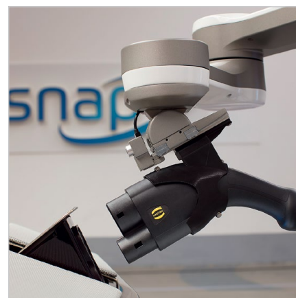
Рис. 4. Разъём Harting для подзарядки электромобиля metroSnap
