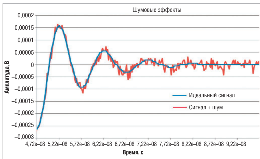
Рис. 6. Идеальная частотная диаграмма затухающего сигнала синусоидальной формы и тот же сигнал с примесью шумов
