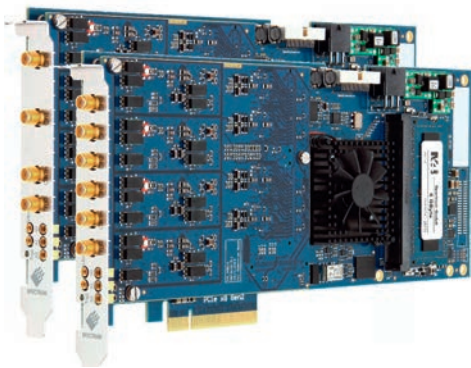
Рис. 10. Дигитайзер Spectrum серии M4i.44xx имеет разрешение до 16 бит и поддерживает скорость передачи данных до 3,4 Гбайт/с
