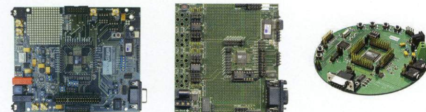
Рис. 4. Внешний вид отладочных плат Anadigm
