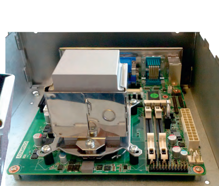
Рис. 13. Установленный на плате теплопроводящий модуль FHC высотой 70 мм
