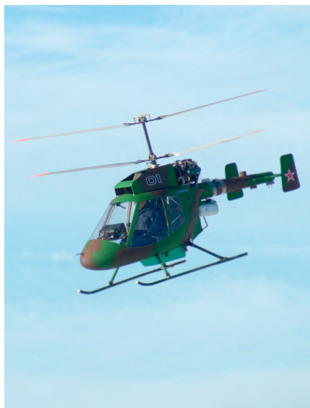
Рис. 2. Сверхлёгкий вертолёт с соосной схемой расположения винтов
