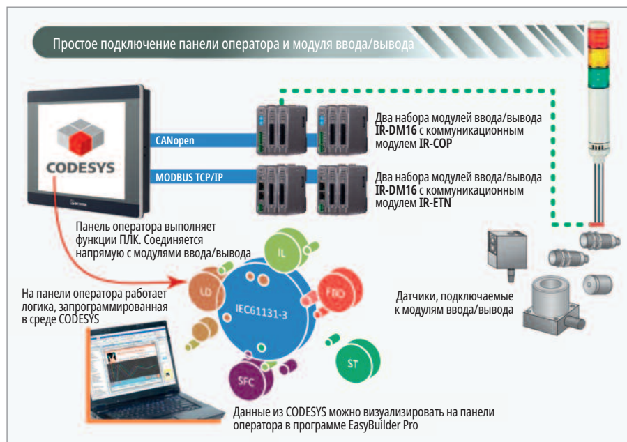
Рис. 5. Решение ЧМИ + CODESYS + система модулей ввода/вывода
