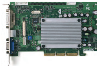
Первая промышленная видеокарта Advantech с интерфейсом AGP — PCA-5640
