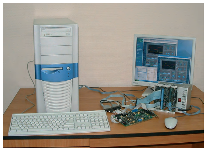
Рис. 5. «Сервер Octagon Systems» с модулем ввода-вывода Advantech PCL-812PG и контроллером MicroPC
