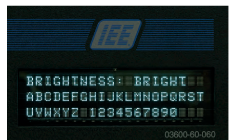
Рис. 3. Вакуумно-люминесцентный дисплей с установленными жёлтым и синим светофильтрами
