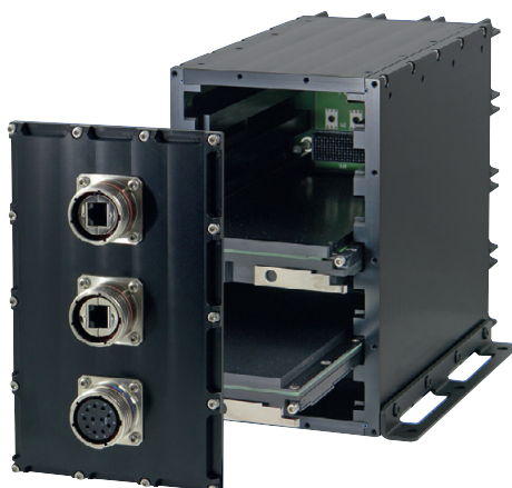
Рис. 8. Корпус шасси может устанавливаться как горизонтально, так и вертикально
