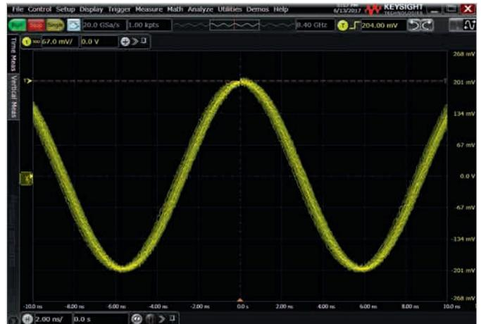
Рис. 3. Установка уровня близко к вершине сигнала на осциллографе Keysight Infiniium серии S
