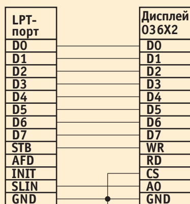
Рис. 5. Схема подключения дисплея к параллельному порту
