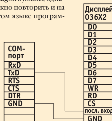
Рис. 7. Схема подключения дисплея к последовательному порту
