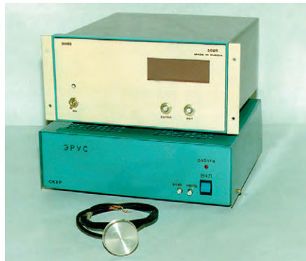
Рис. 5. Внешний вид микроконтроллерного и электронного блоков и акустического преобразователя (АП)
