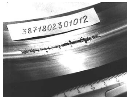
Рис. 1г. Вид поврежденной беговой дорожки наружной обоймы роликоподшипника. Максимальная стадия (незадолго до разрушения): повреждена вся поверхность беговой дорожки
