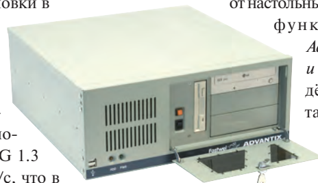
Рис. 1. Станция оператора АСУ IPC-SYS1-1/IPC-SYS1-2
