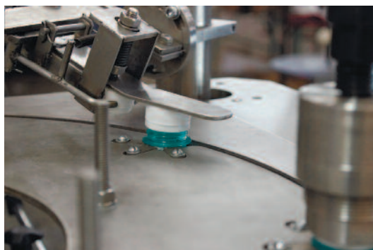
Рис. 2. Пневматический блок с электронным управлением для крышек ПЭТ (полиэтиленовой тары) линии ЛР-5-1000
