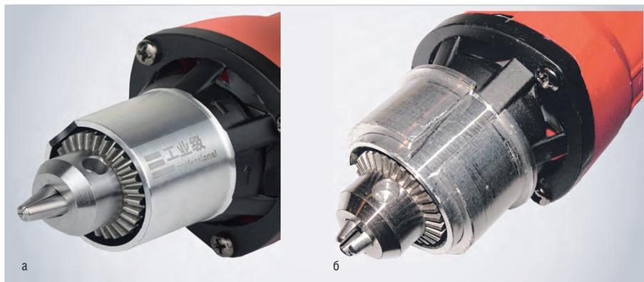
Рис. 11. Фотография цилиндрической части корпуса: а) мини-дрели; б) установленного переходного кольца
