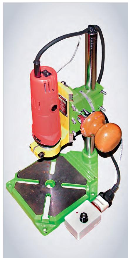
Рис. 9. Фотография стойки SKRAB 25519 с мини-дрелью TUNGFULL 1806В и устройством на базе U2010В в сборе
