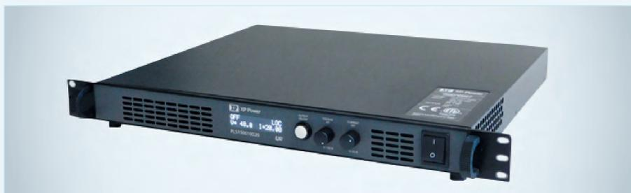
удобную регулировку выходного напряжения и тока. Так как органы управления чувствительны к скорости, медленное вращение позволяет производить точную настройку с точностью 0,1%. Встроенные 12-разрядный цифро-аналоговый и аналого-цифровой преобразователи позволяют также измерять напряжение и ток с аналогичной степенью точности. Эта возможность экономит средства и пространство для дополнительных измерительных приборов.
