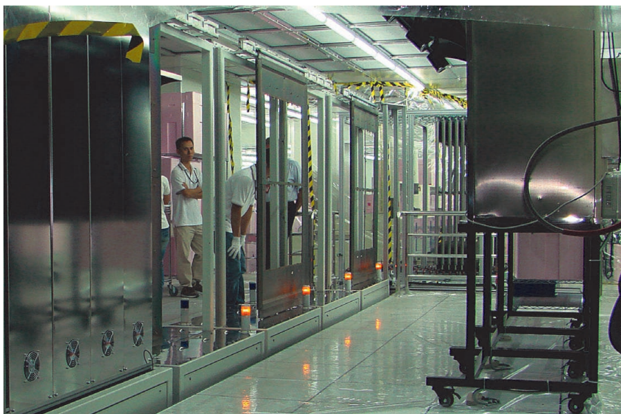
Рис. 4. Столы загрузки-разгрузки кареток транспортной системы с установленными каретками
