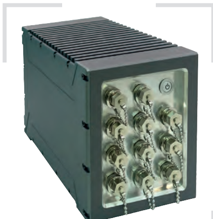
Рис. 9. Встраиваемая система Perfectron F1, построенная на основе StackPC, для применения на транспорте
