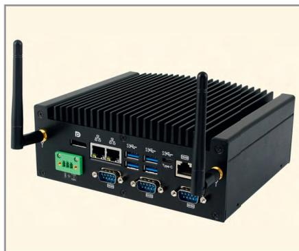
**Рис. 3. Безвентиляторный встраиваемый компьютер iBASE ASB200-915 на базе платы IB915 с процессором Skylake**
