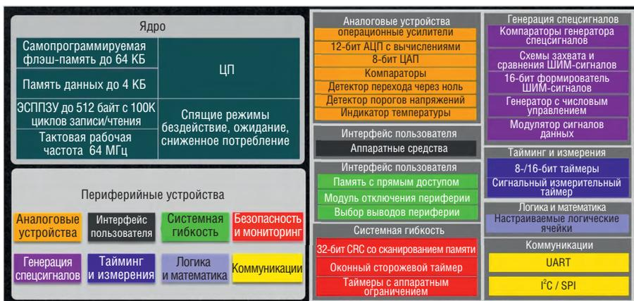
Рис. 6. Структура микроконтроллеров серии PIC18F04/05/06Q41
