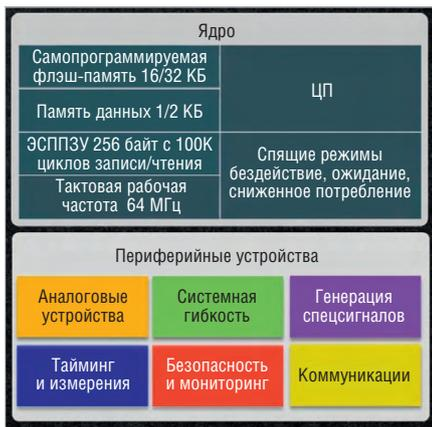
Рис. 4. Структура микроконтроллеров серий PIC18F24/25Q10
