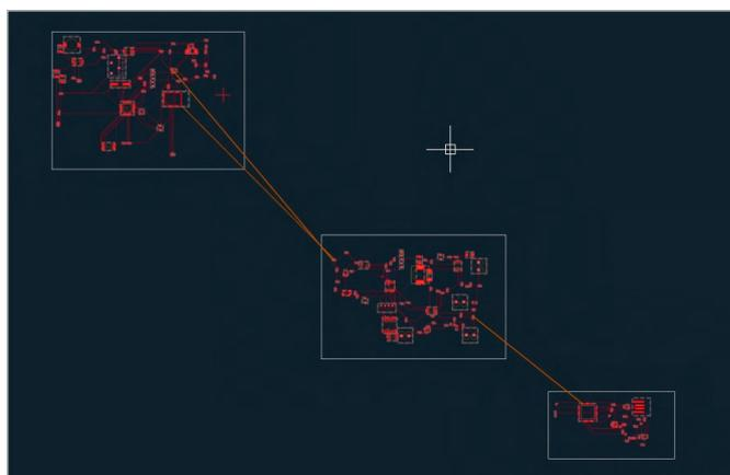
Рис. 27. Трассировка всех контуров блоков A1, A2, A3 в редакторе печатной платы общего проекта
