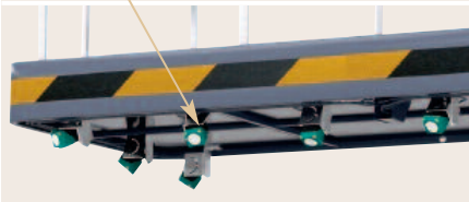
Рис. 8. Ультразвуковые датчики контролируют опасное сближение платформы с посторонними объектами
