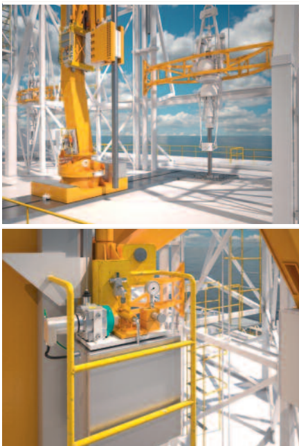
Рис. 12. Применение тросового механизма с пристыкованным энкодером для контроля перемещений механизмов буровой установки
