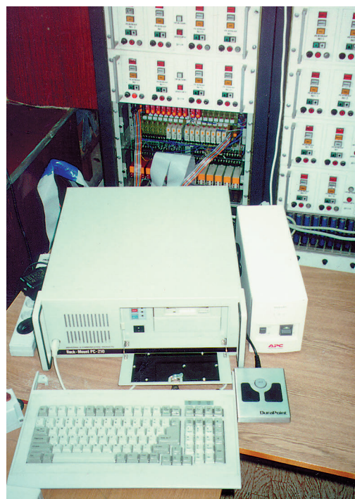
Рис. 4. Информационно-измерительный комплекс на базе техники Advantech. На заднем плане видны сохранившиеся стойки KOR-VOL
