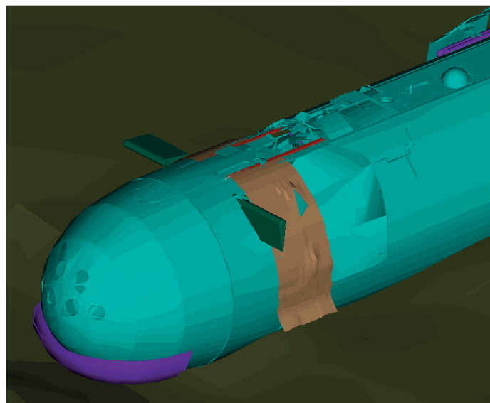
Рис. 6. Компьютерный проект укрытия АПЛ «Комсомолец»
