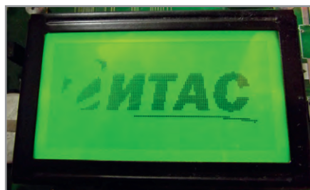
Рис. 10. Пример неудачного вывода изображения в режиме «256 градаций серого»: некоторые светло-серые элементы не видны
