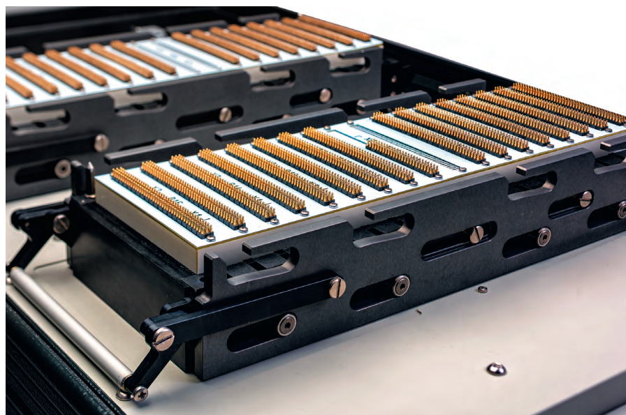
Рис. 5. Прецизионное прижимное устройство измерительного блока
