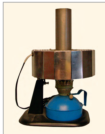
Рис. 9. Действующая модель генератора на керосиновой лампе [7]
