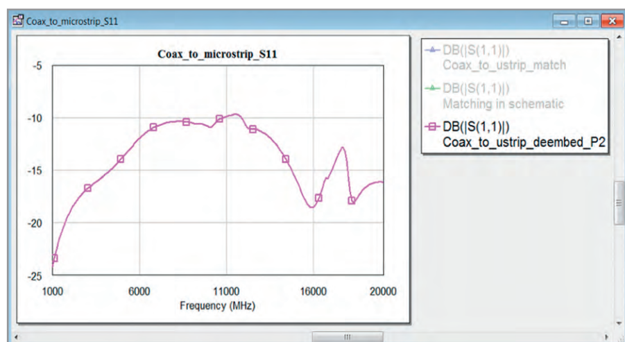
Рис. 3. График частотной зависимости модуля коэффициента отражения от входного порта коннектора до его оптимизации
