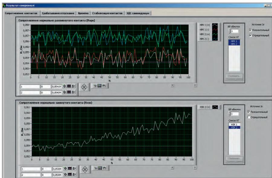
Рис. 7. Отображение на встроенном осциллографе процесса приработки контактов реле
