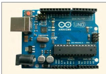
Рис. 1. Плата Arduino Uno
