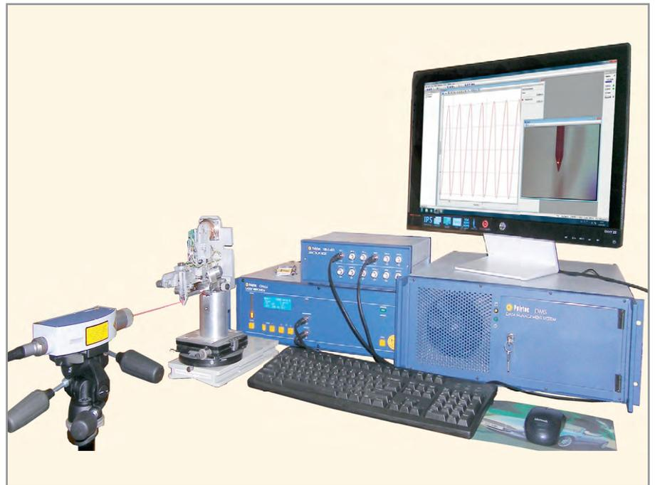
**Рис. 2.** Лазерный бесконтактный виброметр CLV-2534 производства Polytec
