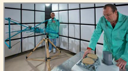
Сотрудники компании регулярно посещают специализированные мероприятия. На выставке EMV-2016 для оснащения собственной испытательной лаборатории ЭМС были приобретены излучающая антенна с рабочим диапазоном 1–18 ГГц и высокочастотный генератор.
