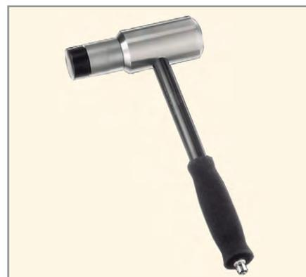
Рис. 18. Измерительный молоток 9728А20000
