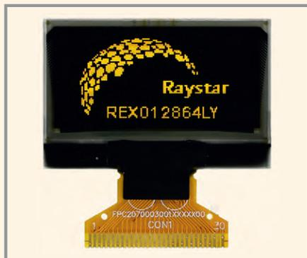
Модельный ряд REX012864L включает следующие варианты дисплеев: REX012864LYAP3N00000 (жёлтый цвет свечения) – яркость 120 кд/м<sup>2</sup> (тип.), REX012864LWAP3N00000 (белый цвет свечения экрана) – яркость 100 кд/м<sup>2</sup> (тип.), REX012864LSAP3N00000 (небесно-голубой цвет) – яркость 100 кд/м<sup>2</sup> (тип.).
