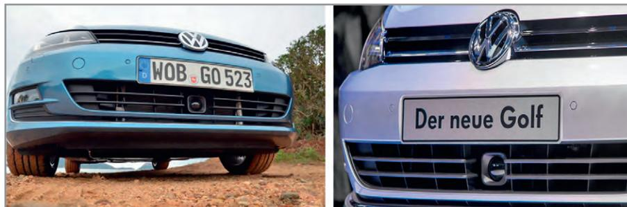
Рис. 11. Размещение радарного датчика в автомобилях производства Volkswagen
