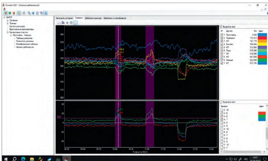
Рис. 7. Графики показаний расходомеров без калибровки
