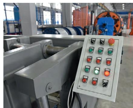
Рис. 2. Блок управления подачи компонент магистрального кабеля
