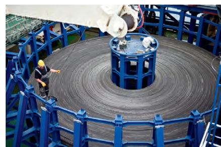
Рис. 3. Намоточная машина в производственном цехе
