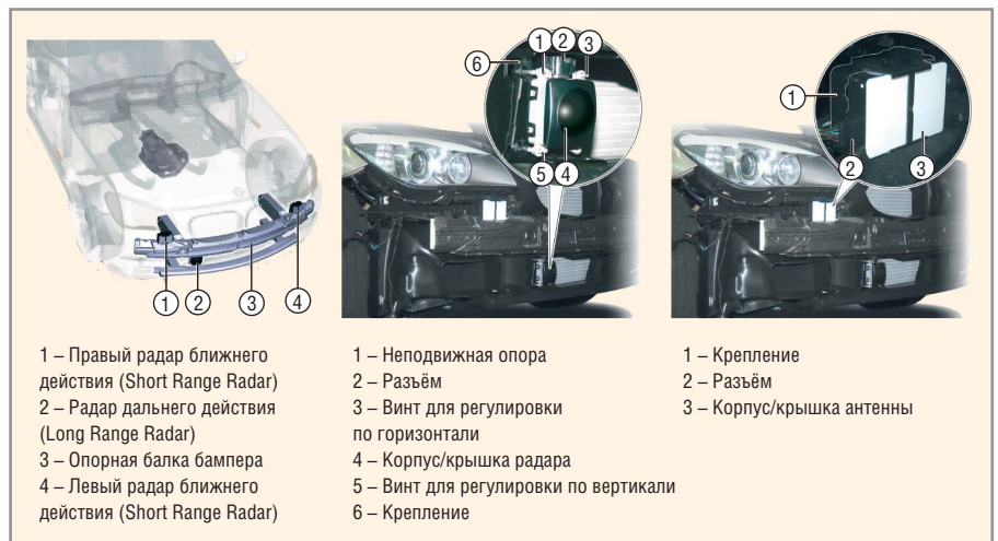
Рис. 8. Расположение радарных датчиков ближнего и дальнего действия в автомобиле BMW
