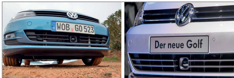
Рис. 11. Размещение радарного датчика в автомобилях производства Volkswagen
