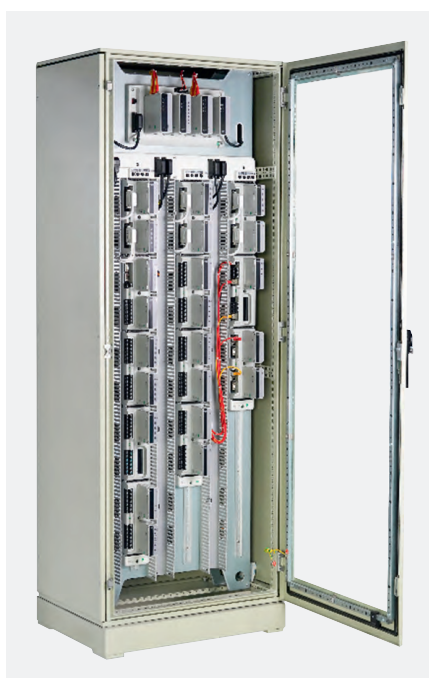
Рис. 5. Распределённая система управления (PCU) MAS 8600
