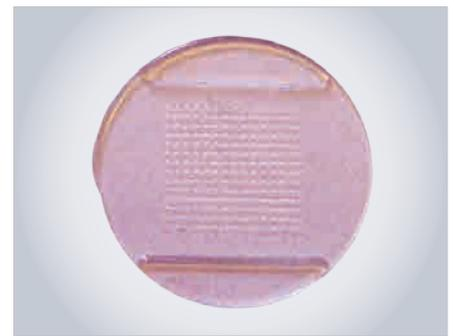
**Рис. 48. Образец матричного объёмного линзового растра**
